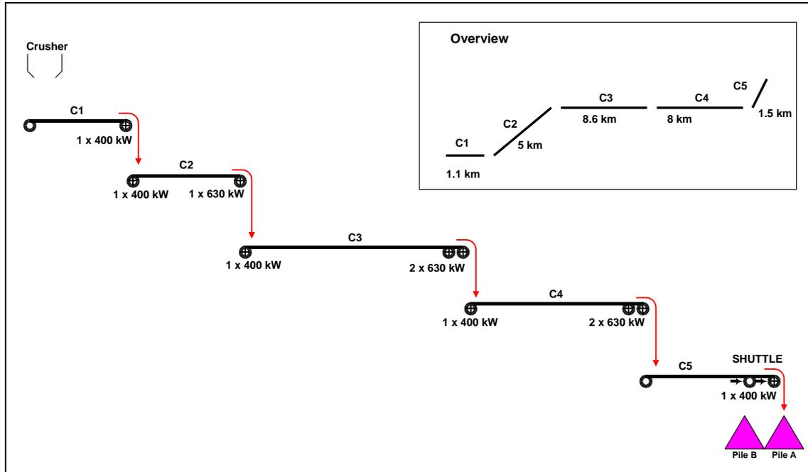
Fig. 3 Indo Kodeco System Layout
